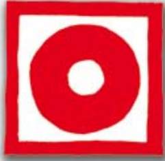
Pulsador de incendio
