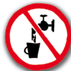
Prohibido beber. Agua no potable
