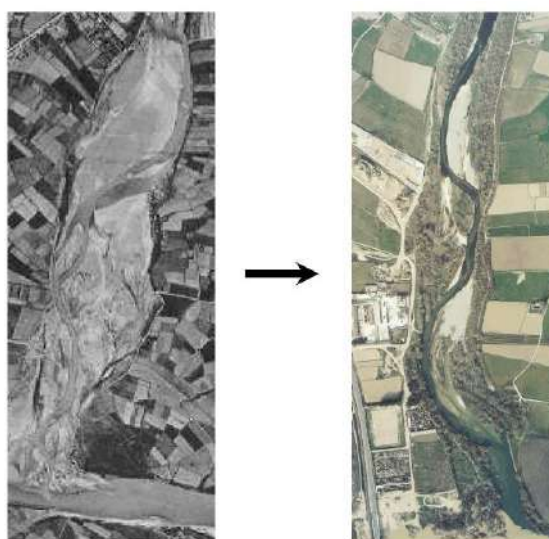
Figura 20.-Ejemplo de cambio de tipo morfológico en planta: divagante a sinuoso.
